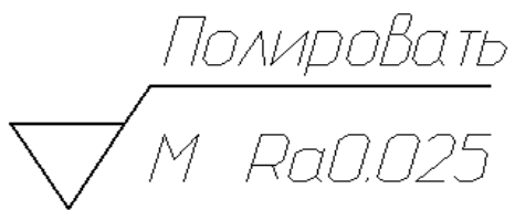
Рисунок 5. Пример указания вида обработки поверхности
